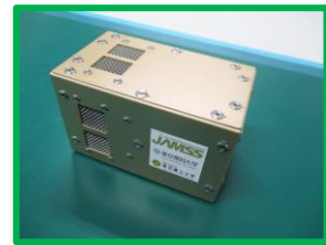
図-13：有人宇宙システム株式会社・東京理科大学・東京農工大学が開発した光触媒空気浄化装置のフライトモデル(Credit: JAMSS) [NO.071]
