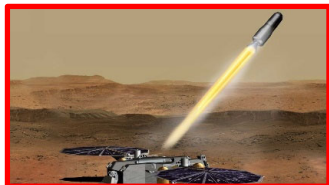
図-5：火星上昇機(以前のNASA設計)は、火星表面から発射され、Perseverance着陸機が収集したサンプルを軌道に運搬 (Credit: NASA)[NO.029]
