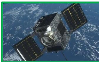
図-5 : 2020年12月に打上げられたHawkEye 360の衛星は、旧型モデルよりも大幅に大きい。多重同時信号収集向にオンボード・パワー増加のためのプロセッサアップデートとより大きな太陽電池アレイを含む(Credit: HawkEye 360)[NO.035]
