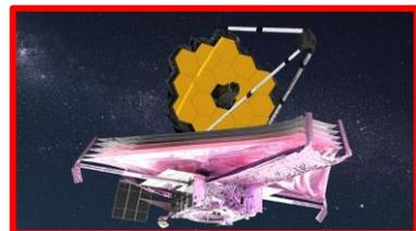
図-2 : JWSTのサンシールドのデプロイメントは、宇宙望遠鏡の展開における主要ステップ(Credit: NASA GSFC/CIL/Adriana Manrique Gutierrez) [NO.004,5]
