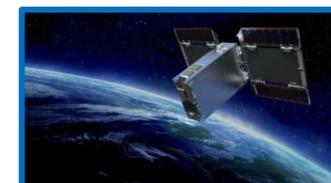
図-18 : ソニーの6Uキューブサットの概念図。衛星には、フルフレームカメラの1つを収容。(Credit: Sony)[NO.047]
