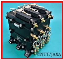
図-15：衛星M I M O技術実証用通信装置(LEOMI-TRX)開発モデル外観 [NO.024]
