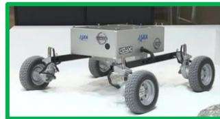
図-17：日産とJAXAによる共同開発の月面探査車 [NO.014]
