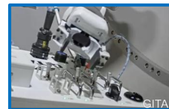
図-18：GITAI、国際宇宙ステーション(ISS)内で行われた自律型ロボットアームの技術実証に成功した[NO.019]
