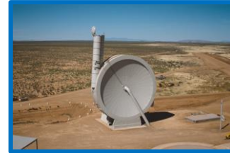
図-9：遠心力でロケットを飛ばすテストで使用された加速器 (Suborbital Accelerator) (写真：ITmedia NEWS) [NO.062]
