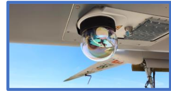
図-13：飛行機の貨物室にインテグレートされたMynaricのHAWK光通信端末[NO.070]
