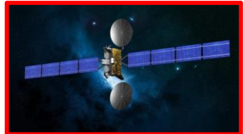
図-2：IAIによると衛星質量は、600-700 kgで最新のデジタルペイロードを搭載(Credit: IAI)[NO.089]
