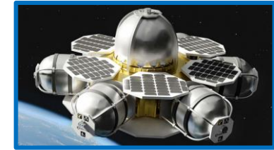
図-12：Orbit Fabのタンカー-002の設計コンセプト (Credit: Orbit Fab) [NO.108]
