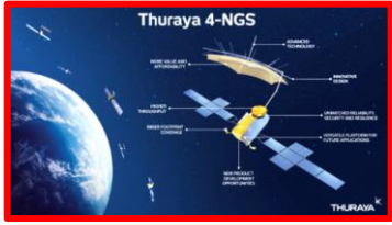
図-1：Thuraya 4-NGSは、全電化エアバスの Eurostar Neoプラットフォームをベース。12mφのL帯アンテナと最大3,200チャンネルまでのルーティングのフレキシビリティを有するP/Lを搭載[NO.009]
