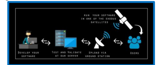
図-11 : 人工衛星を利用したエッジコンピューティングの概念図 (Credit: Exodus Orbitals) [NO.073]
