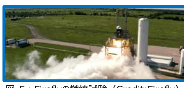
図-5：Fireflyの燃焼試験 (Credit: Firefly) アルファロケットは、急成長する小型衛星市場に対応。LEOに1トン、高度550kmのSSOに630kgのペイロードを打上げ可能。また、専用打上げ及びライドシェアの両方に対応可能。[NO.015]
